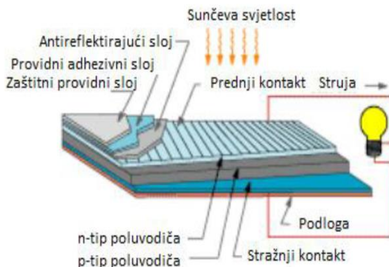
Slika 13. Struktura FN ćelije
